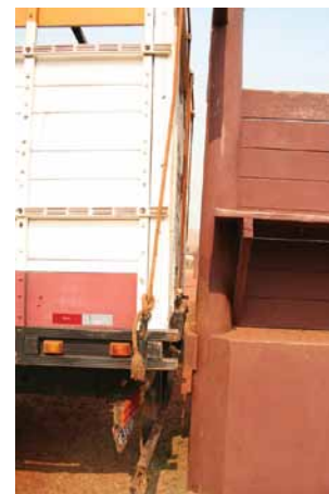
SE DEBE EVITAR ESPACIOS ENTRE EL CAMIÓN Y EL EMBARCADERO.
